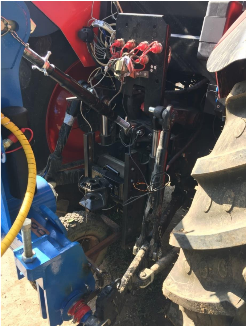
Рис. 3.7. Общий вид размещения тензометрических звеньев, фиксирующих тяговое сопротивление орудия
