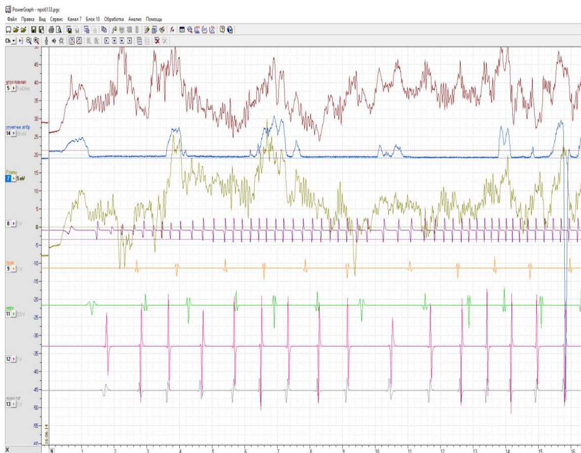
Рис. 3.4. Фрагмент экспериментальных осциллограмм регистрируемых силовых и кинематических параметров трактора. Измерительные параметры трактора Zetor ANT-4135F
