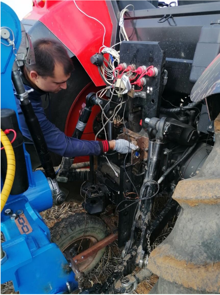
Рис. 3.9. Измерение действительной скорости движения трактора
