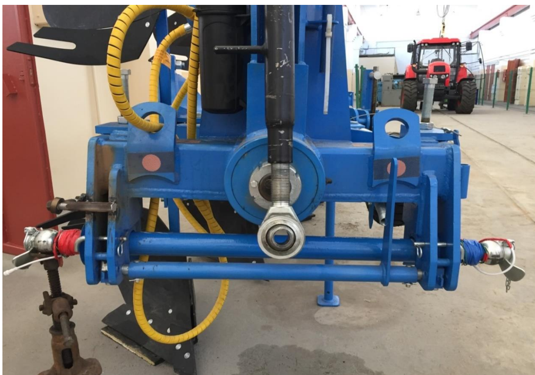
Рис. 3.6. Размещение тензометрических звеньев в конструкции почвообрабатывающего орудия
