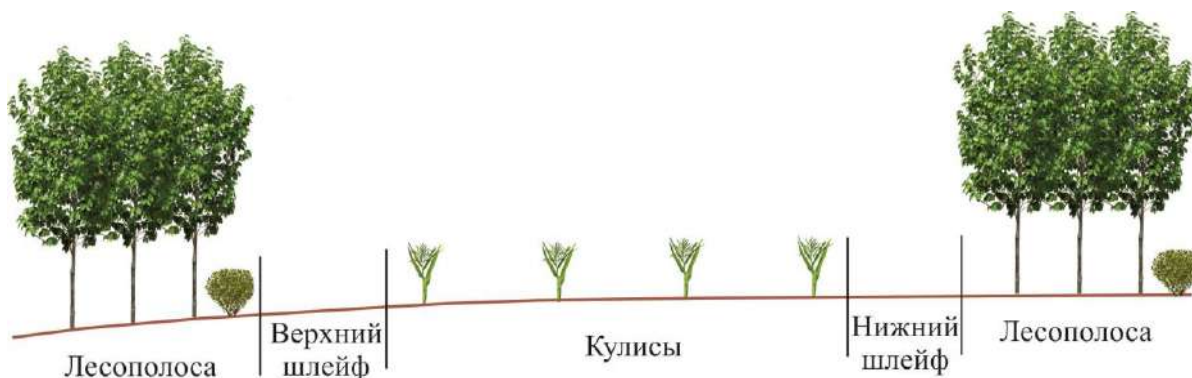
Рис. 3.24. Схема стокорегулирующих лесополос с кулисами из высокоствельных сельскохозяйственных растений в межшлейфовом пространстве
