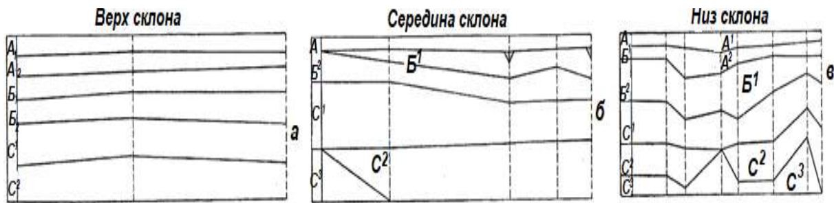
Рис. 141. Почвенные профили, пересекающие склон в его приводораздельной части, в середине и подножии (составлены И. С. Черниковым на Новосильской опытно-овражной станции по обнажениям в свежевыкопанных канавах вдоль водозадерживающих валов)
