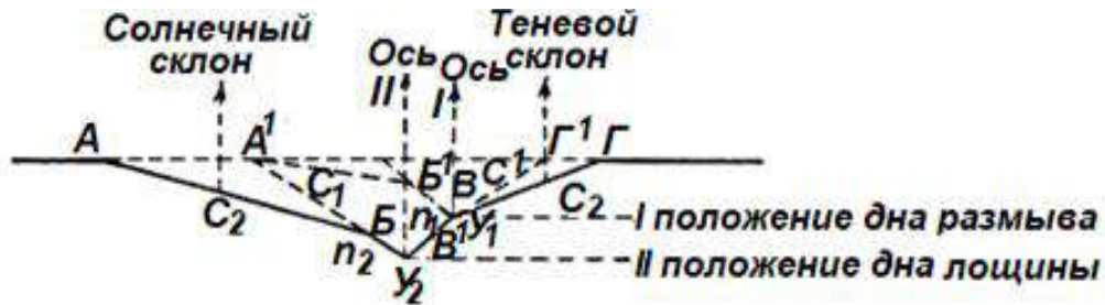
Рис. 38. Схема развития суходола при усиленном развитии второй стадии эрозионного цикла (усиленное сглаживание откосов протока) и слабом его углублении и подмыве (обратная асимметрия).
