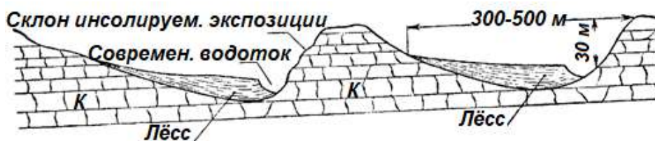
Рис. 86. Поперечный профиль через два рядом лежащих суходола по территории, примыкающей к приволжской гористой зоне. Водосбор р. Терешки близ г. Хвалынска (к – коренная (меловая) порода)
