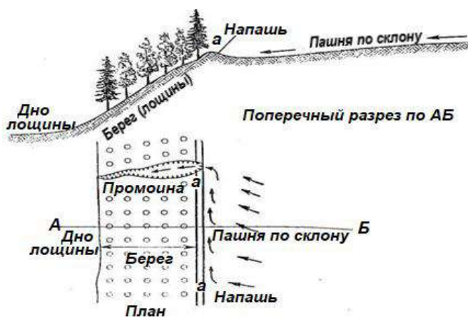
Рис. 43. Влияние пограничной около леса напашей (а) или канавы на развитие берегового размыва в облесенном берегу
