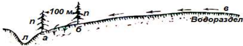
Фиг. 11. Схема мелиорации бросовых смытых земель замкнутыми ветроломными лесными полосами (разрез по склону: аб – смытые присетевые участки склона; в – водораздел; л – лощина; nn – замкнутая лесная полоса)
