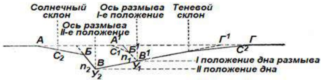
Рис. 37. Схема развития суходольного звена гидрографической сети при усиленной первой стадии эрозионного цикла (усиленное углубление и подмыв протока и слабое сглаживание откосов протока):
