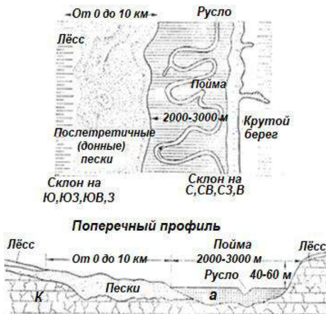
Рис. 51. План и поперечный профиль речной долины второго типа:
