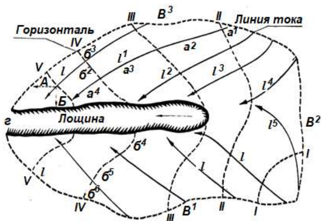
Рис. 5. Расположение линий тока и горизонталей на склонах к лощине:
