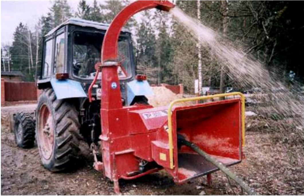
Рисунок 6.4 - Рубильная машина Каваста ВХТ6238i-m - Умелец
