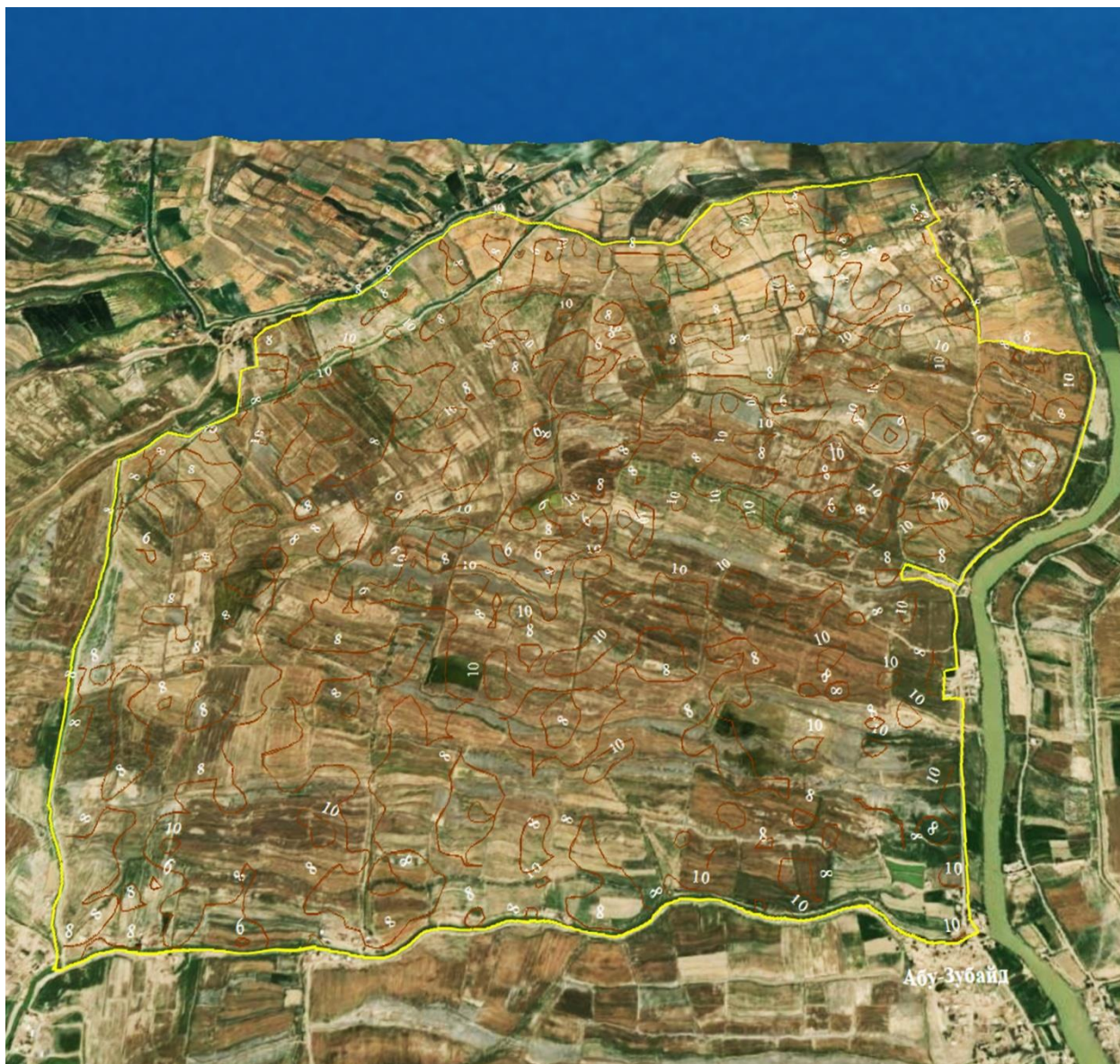
Рисунок 4.63 - Визуализация 3-х мерной модели рельефа на территории полигона «Кабир» с изолиниями высот рельефа и линией профиля
