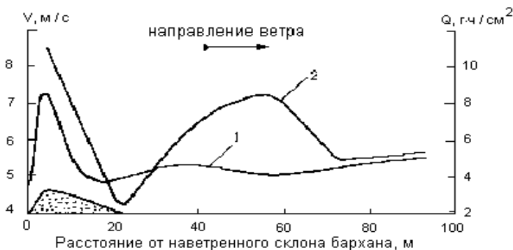
Рис. 7.17. Изменение скорости V потока (1) и массы Q переносимого песка (2) на высоте 10 см над барханом и эродируемой почвой при восточном ветре 7,6 м/с на высоте 2 м (сентябрь 1984 г.)
