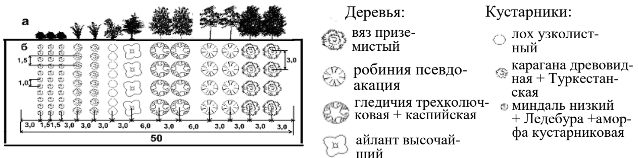
Рис. 19.18. Защитная лесополоса "изолирующего" типа: а – разрез, б – план
